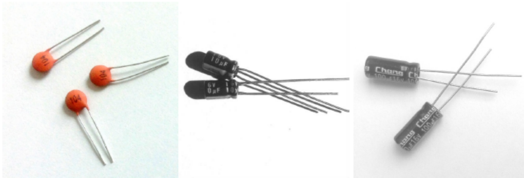
Afbeelding 10: Verschillende soorten condensatoren
